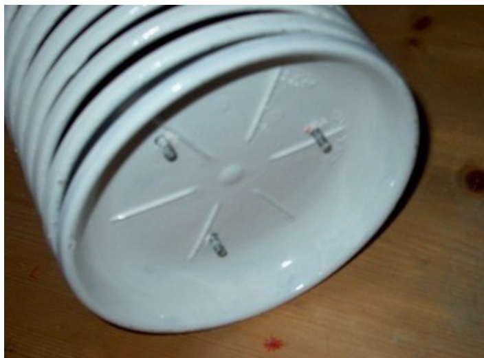
Il sensore è posizionato, si può chiudere ed avvitare lo schermo solare.
